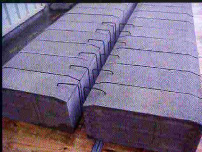
Los estribos necesarios en las cabezas de los nervios se suministran montados y unidos entre sí por una barra soldada con las separaciones que el cálculo determine. Las barras longitudinales se colocan dejándolas caer dentro del estribo.
